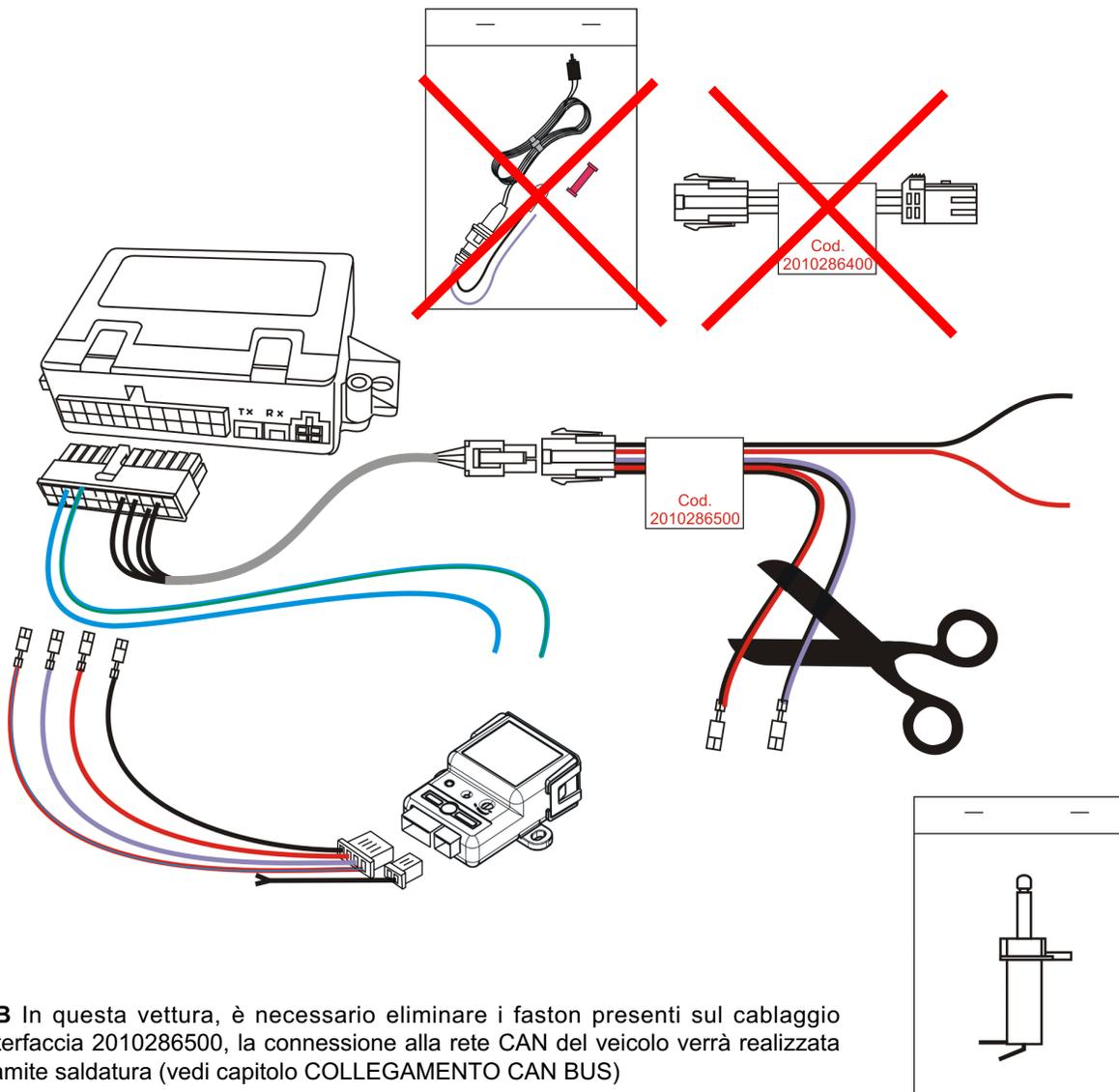
**NB** In questa vettura, è necessario eliminare i faston presenti sul cablaggio interfaccia 2010286500, la connessione alla rete CAN del veicolo verrà realizzata tramite saldatura (vedi capitolo COLLEGAMENTO CAN BUS)
